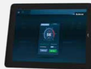
Het Connect Center Pro van Bosch verbindt de verwarmingsketel met het internet.
