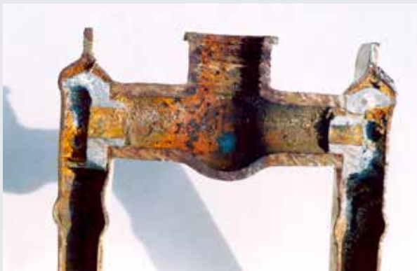
Verstopping in een radiator door zoutafzetting van een inhibitor met vuil.
