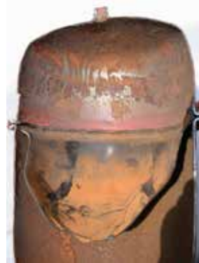
Coupe vase d'expansion avec dépôt de corrosion sur la membrane.
