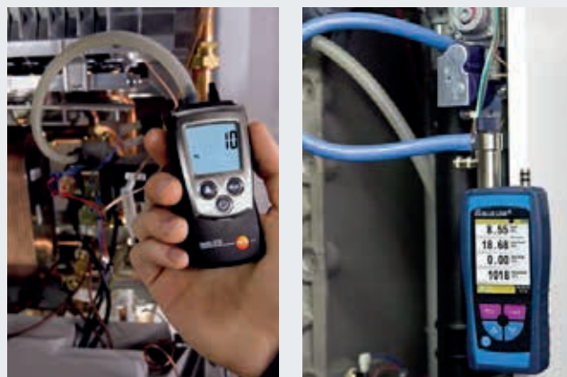
Metten met een elektronische drukmeter
