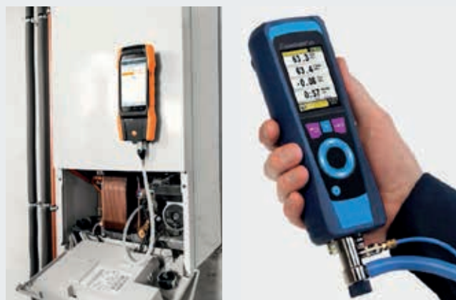
Metten met een elektronische drukmeter
